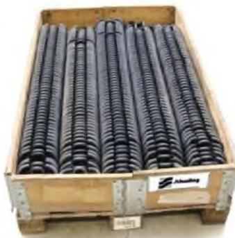
Сортированные поставки клемм оптимизируют их монтаж на шпальных заводах и позволяют автоматизировать производственные процессы
